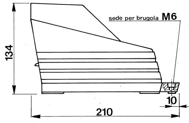
Questi pedali sono costruiti in materiali termoplastici ad alta resistenza e zavorrati per aumentare la stabilità con una piastra in acciaio. Peso kg. 1.
